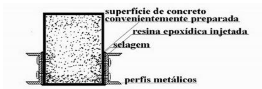
Figura 04 – Reforço por chumbamento de perfis metálicos
