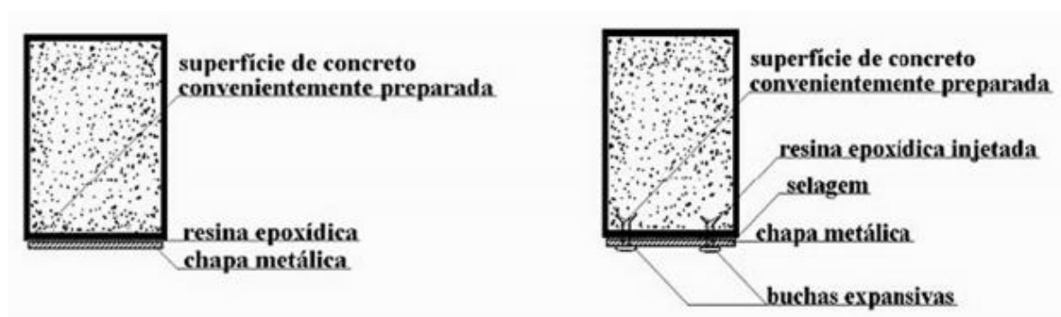
Figura 03 – Reforço em chapas metálicas, só com colagem (à esquerda) e também com chumbamento
